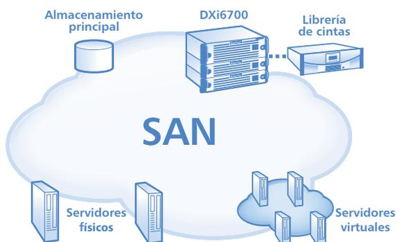
*DXi6700 es un dispositivo de copia de seguridad en disco de alto rendimiento, fácil implementación, asequible y con de-duplicación de datos, que proporciona soluciones sencillas a los problemas relacionados con las copias de seguridad y que se integra fácilmente en entornos de Fibre Channel.*
